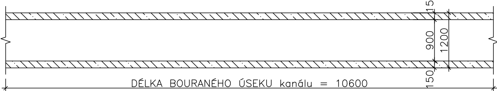
PŘÍČNÝ ŘEZ BOURANÝM TEPELOVODNÍM KANÁLEM M 1:50
